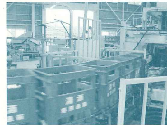
「お酒のケース」の洗浄の様子。 全国から回収、洗浄、リユースします。
