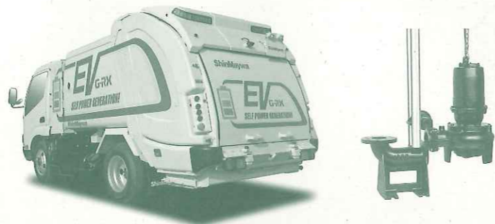
左:《特装车》外部電源からの充電が不要の電動式塵芥車(ごみ収集車)
